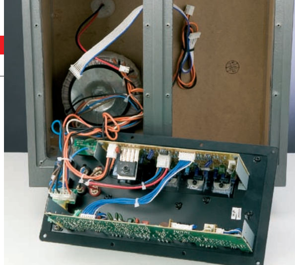
Il pannello posteriore del subwoofer chiuso per il sistema 2.1 e aperto con il secondo vano per l'alloggiamento dell'UpGrade a 5.1 canali (notare il generoso dimensionamento del toroidale di alimentazione).
