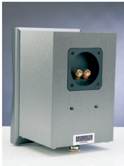
Il pannello posteriore del satellite con i morsetti dorati a vite che accettano connessioni con cavo spellato, forcelle o banane; la basetta del filtro di crossover è solidale alla vaschetta degli ingressi.
