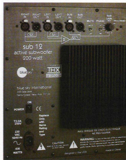
Anche l'elettronica (di segnale e di potenza) del sub è fissato al pannello posteriore, provvisto di dissipatore e di connettori d'ingresso.
